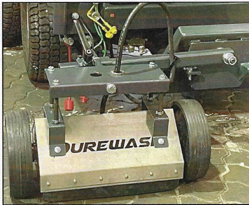
Front mundstykke 40 cm til redskabsbærer. Mundstykket kan vippe til både højre og venstre side, samt forskydes ind og ud.
