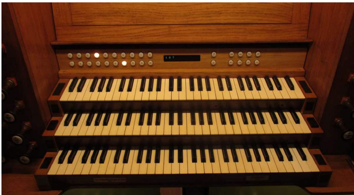
Spillebord i orglet i Tønder Kristkirke, efter indbygning af betjeningstaster og display til sættekombinationer
