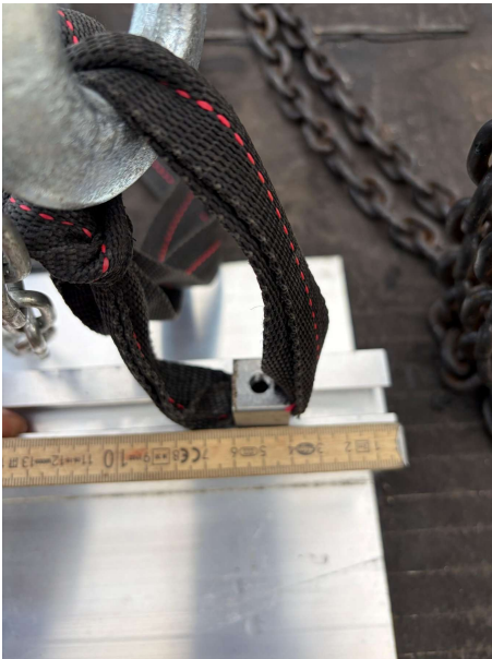
Foto 7. Måling af beslag/prøveemne med tomme stok.
