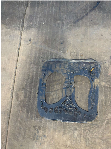
Foto 13. Prøvefelt efter optræk. Materialerester viser delvist brud i tagpappens overflade.
