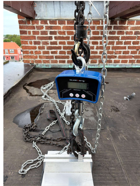
Foto 8. Prøveopstilling før belastning af testbeslag.
