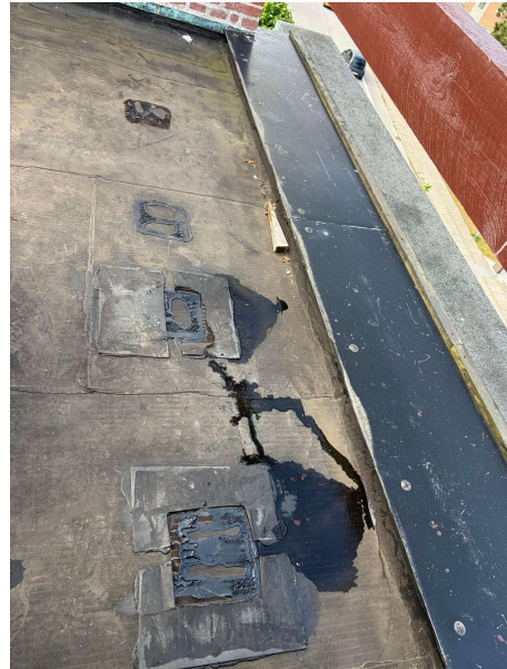
Foto 10. Oversigt over flere prøvefelter efter udført trækprøve.
