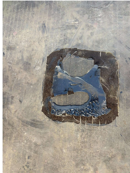
Foto 14. Prøvefelt efter optræk. Brudbilledet viser ikke et rent slip i hele limfladen.
