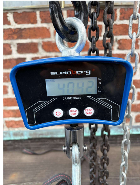
Foto 6. Fotodokumenteret aflæsning på digital kranvægt: ca. 404,2 kg.
