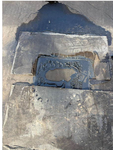
Foto 12. Brudflade efter prøve med synlige rester af klæbemiddel og tagpappmateriale.
