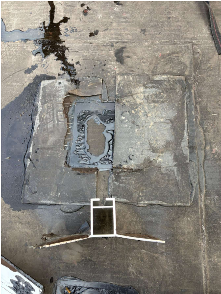
Foto 9. Brudbillede efter trækprøve. Beslag er trukket fri af prøvefeltet.
