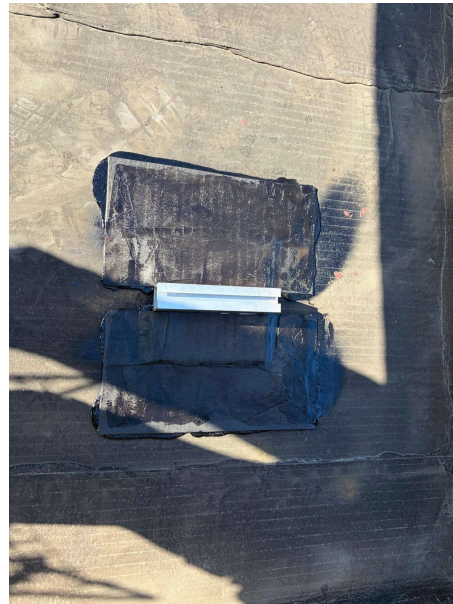
Foto 4. Prøveemne med beslag og svejste/inddækkede lapper før trækprøve.
